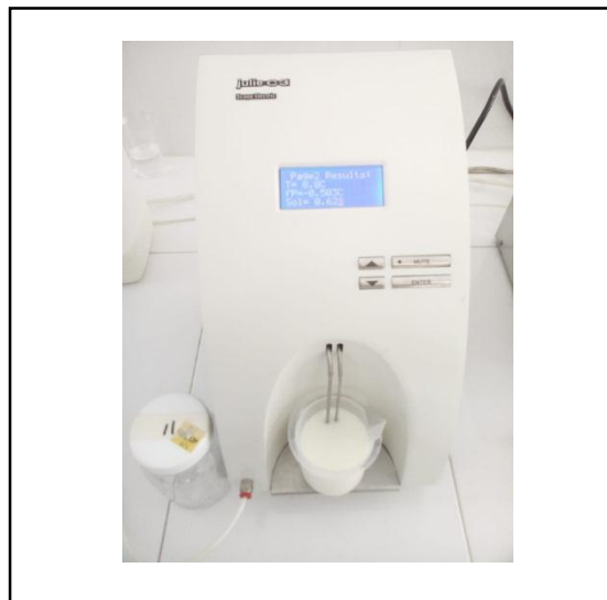
Figura 3. Medidor de la calidad de la leche.
