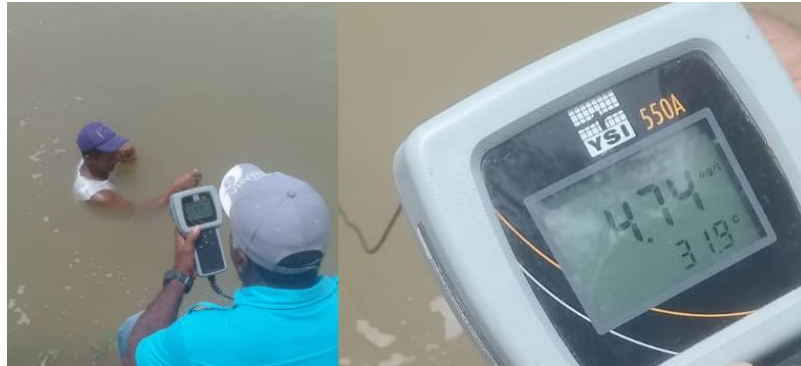
Figura 12. Medición de parámetros físico-químicos del estanque minutos antes de recibir los alevinos. Se observó una concentración de oxígeno de 4,74 mg/l y una temperatura de 31,9°C, estas condiciones son aceptables para el recibimiento de los alevinos.
