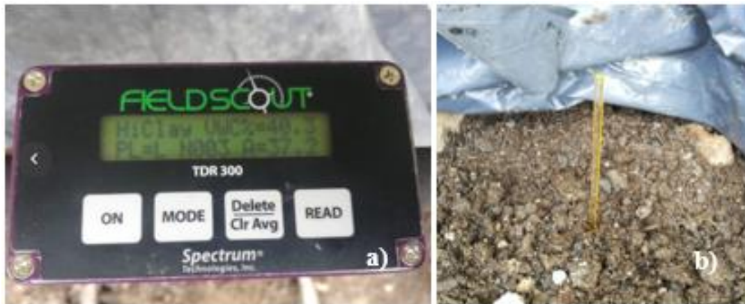
Figura 6. Medición de la humedad (a) y temperatura (b). Fuente: elaboración propia.
