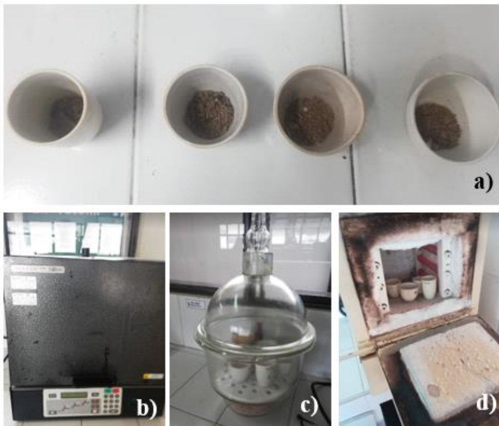
Figura 12. Determinación de la MO por calcinación. a) peso de 10g de la muestra en cada crisol; b) muestra a 105°C; c) muestra en el desecador; d) muestra a 550°C.
