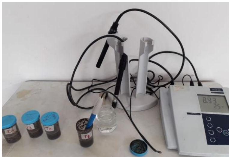
Figura 7. Medición de pH mediante el potenciómetro. Fuente: elaboración propia.
