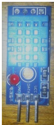
Figura 24: Sensor de humedad y temperatura ambiente.
