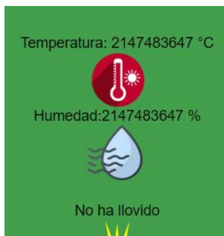
Figura 47: Lectura de temperatura mal tomada por el sensor.
