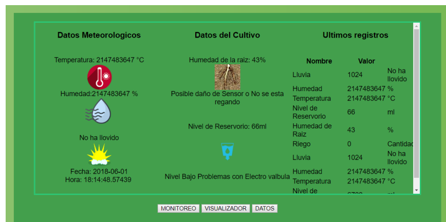
Figura 56: Alteración del nivel, malas lecturas y bajo nivel de solución.
