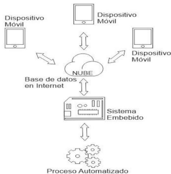
Figura 10: Resumen del sistema completo de control descrito en el artículo.
