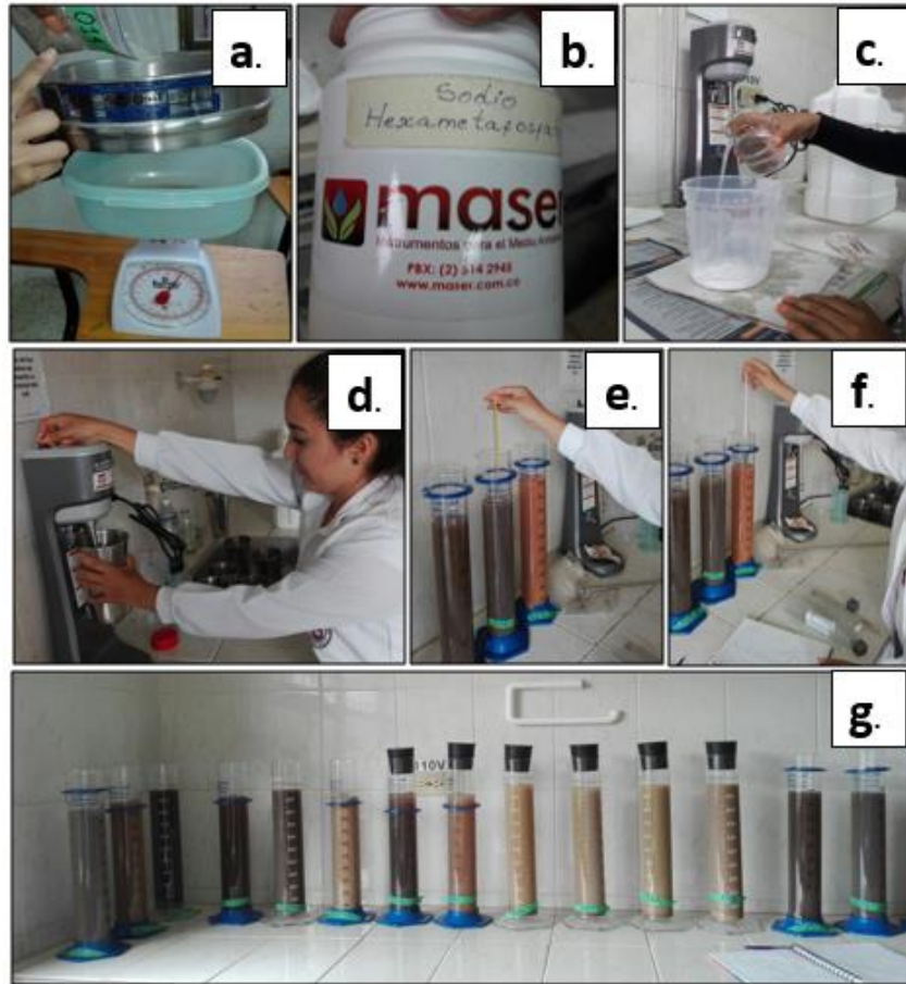
Fotografía 13. Procedimiento de método de Bouyucos
