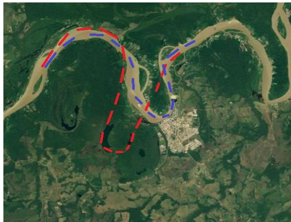
Figura 26. Modificación de la sección hidráulica del Río Guaviare por meandro abandonado
