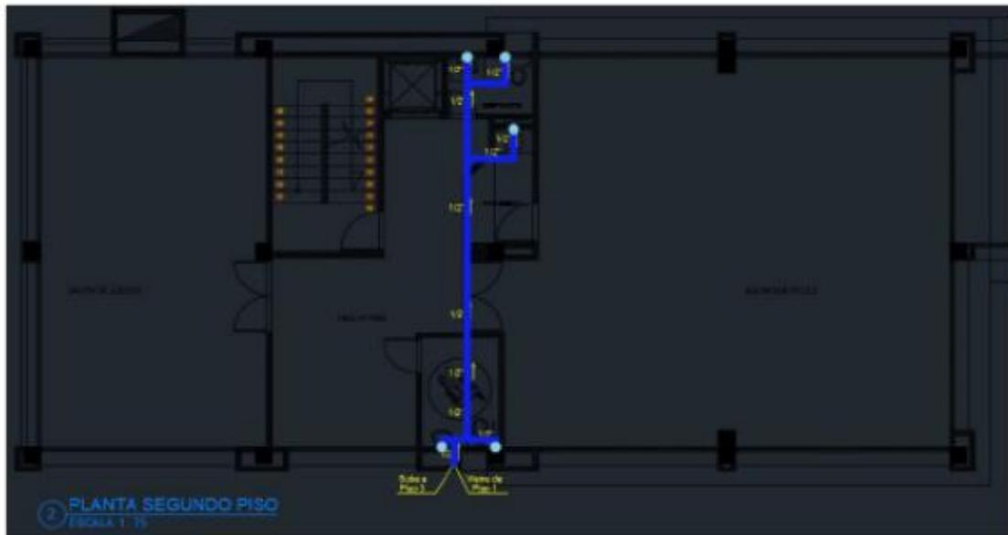
CH\_PLANO 2 HIDRAULICA: Incluye la instalación de la tubería hidráulica (1"- $\frac{3}{4}$ " -  $\frac{1}{2}$ " ), puntos del piso 2 y la montante hidráulica.
