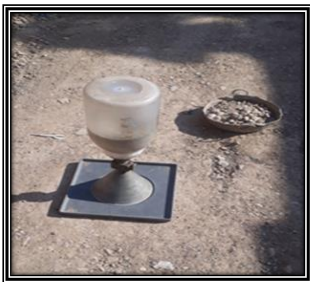
Ilustración 35. Ensayo de Densidad in situ
