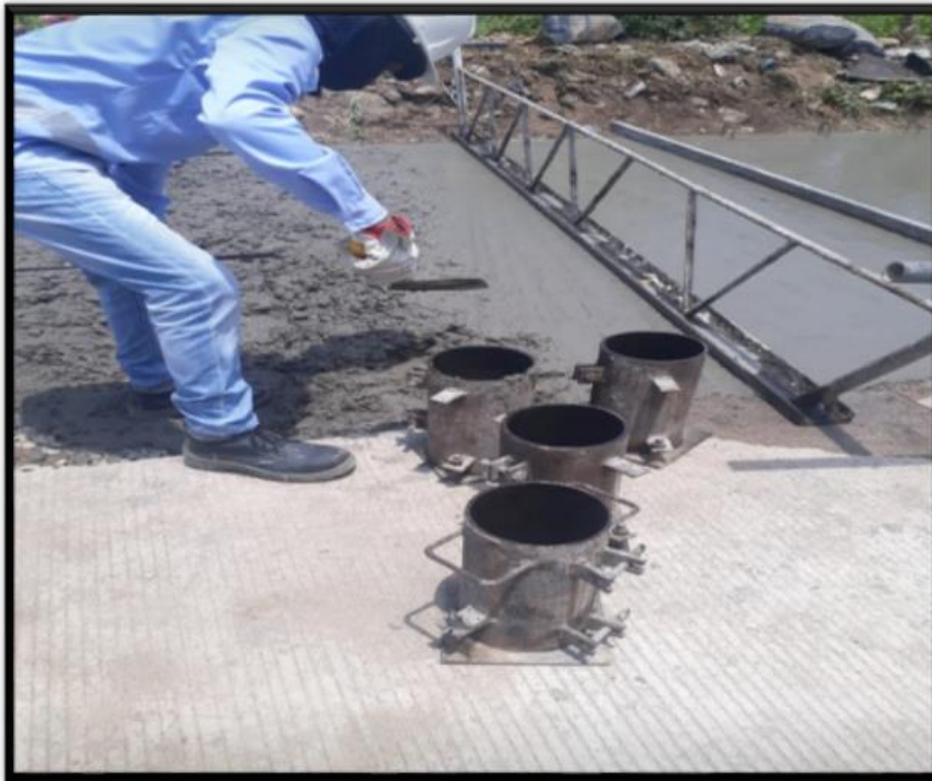
Ilustración 38. Extracción de Muestras para Ensayo a la Compresión de Cilindros de Concreto
