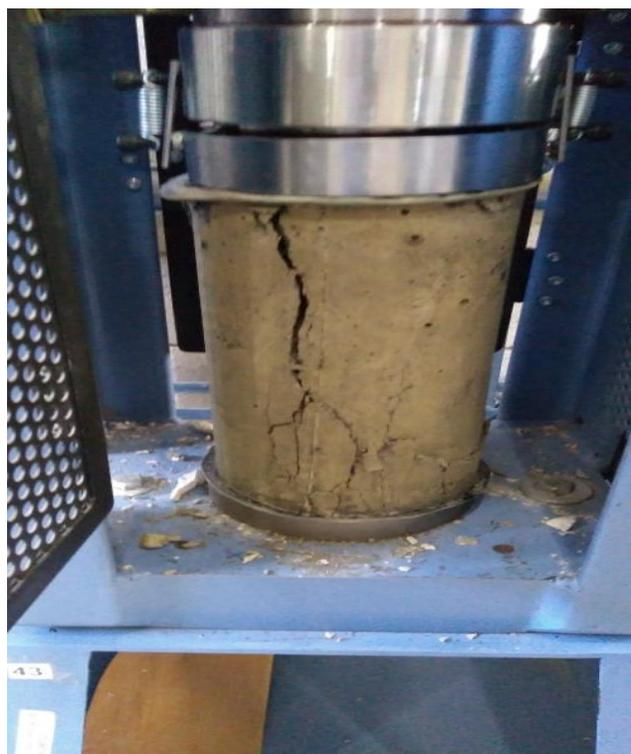
Ilustración 32: Prueba de cilindro en maquina universal.
