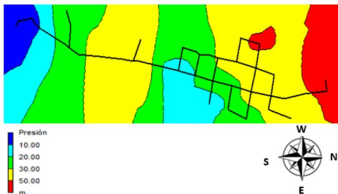
*Figura 36.* Modelo de elevación digital de implementando válvula reductora de presión con consigna de 17 mca y diámetro mínimo de 3”.
