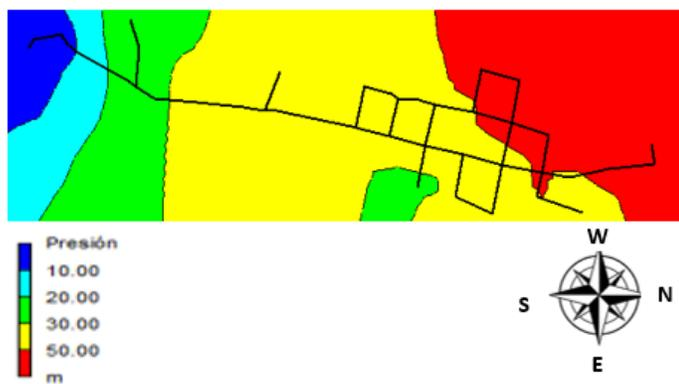
Figura 32. Modelo de elevación digital de implementando válvula reductora de presión con consigna de 30 mca.
