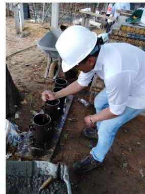
Elaboración de cilindros para prueba de resistencia a la compresión del concreto
