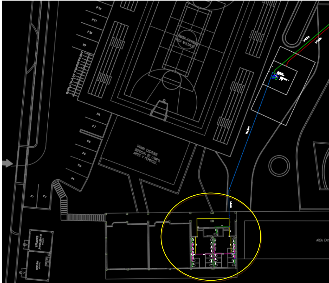
Figura 28. Planta Red Hidráulica bloque 1, Planos Camilo Torres
