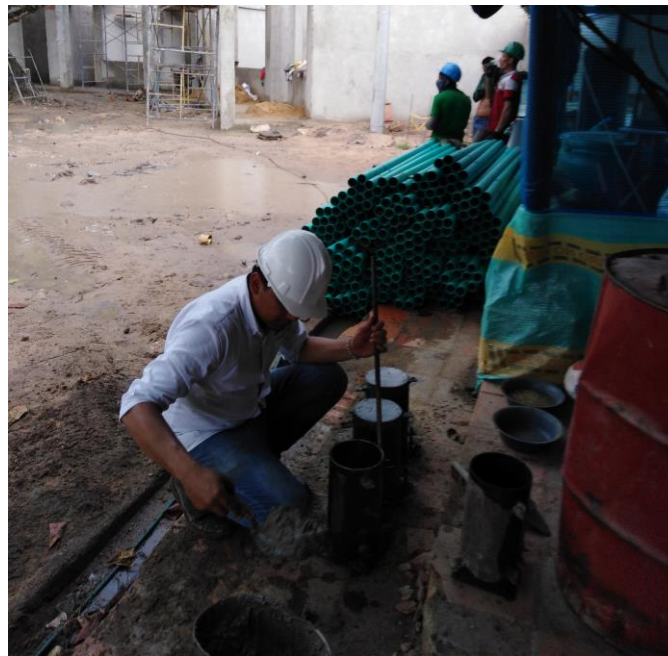
Figura 22. Elaboración de Cilindros de concreto
