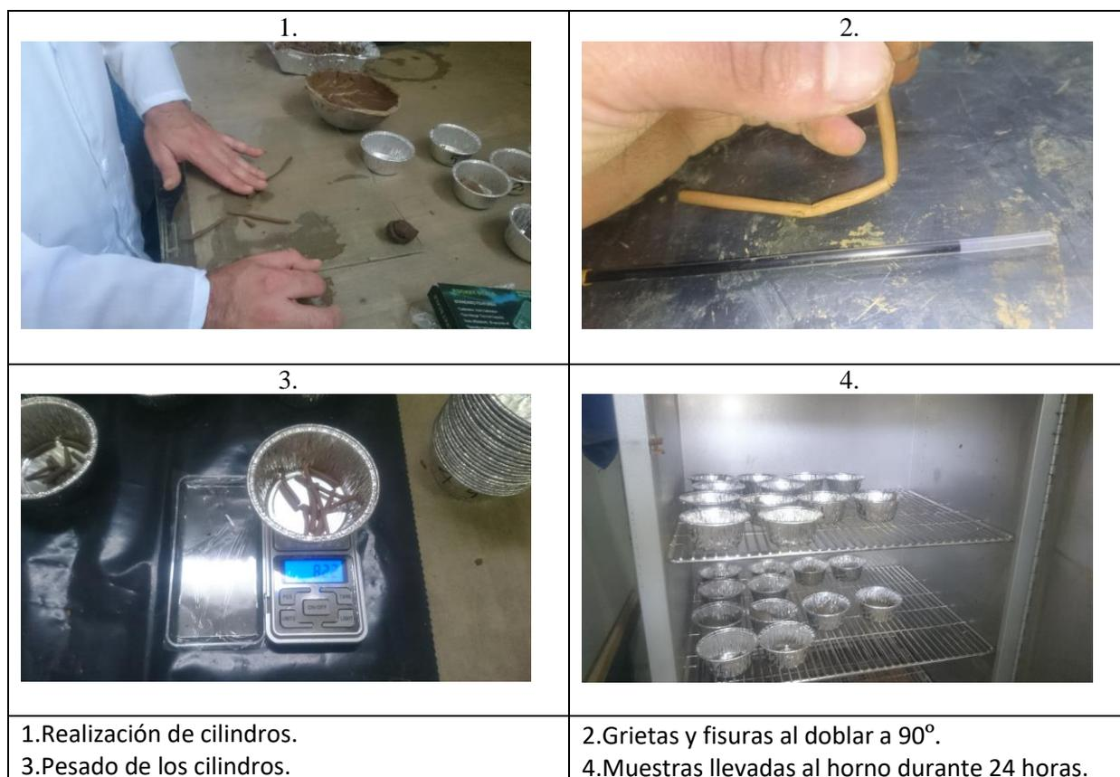
*Figura 27.* Proceso para determinar límite plástico.
