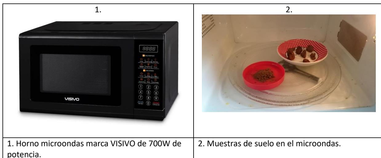
Figura 23. Horno microondas utilizado en el ensayo VMO-D07BL
