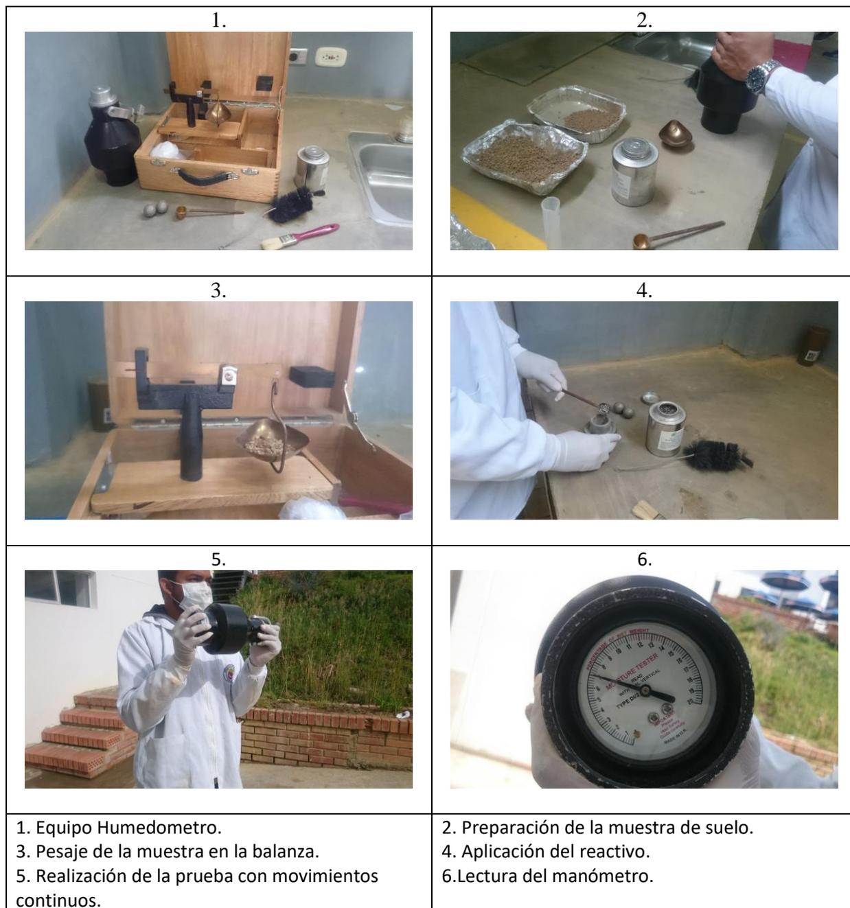
Figura 22. Procedimiento Humedómetro (Speedy).
