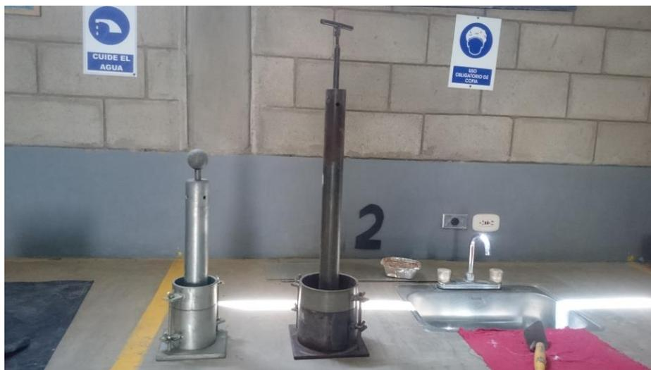
Figura 12. Comparación de los martillos para la prueba Proctor estándar (izquierda), modificado (derecha) y moldes de 4",6".
