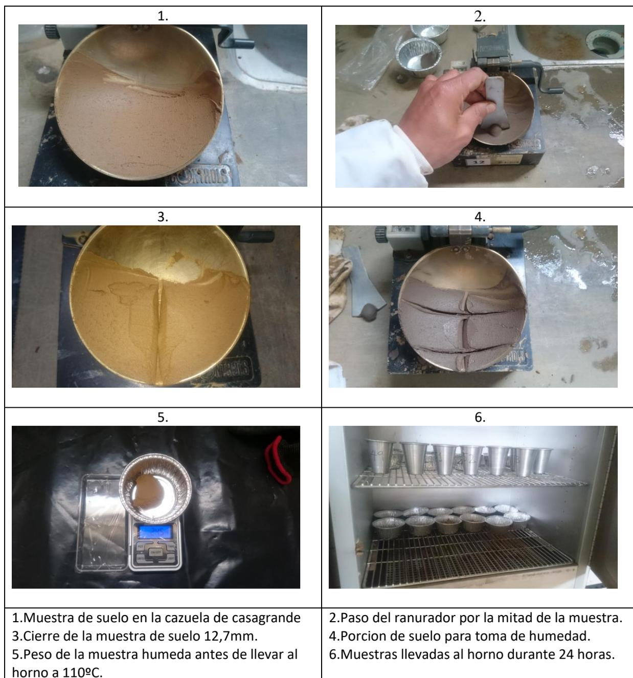
*Figura 26.* Proceso para determinar límite líquido.
