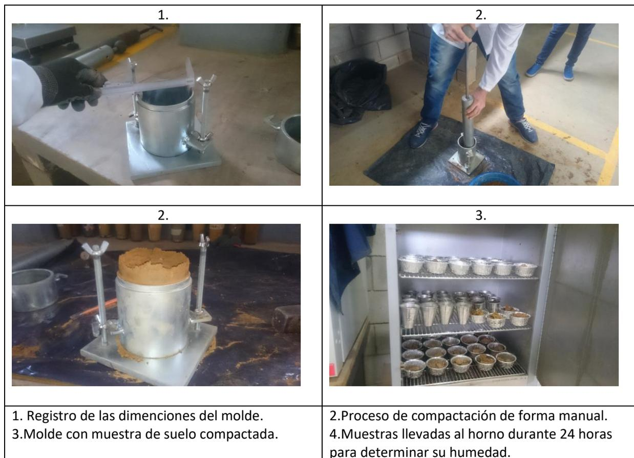
*Figura 28. Procedimiento ensayo de Proctor.*
