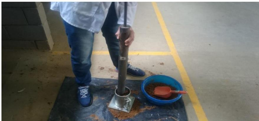
*Figura 29.* Compactación Proctor modificado 5 capas, 25 golpes por capa y molde de 4".
