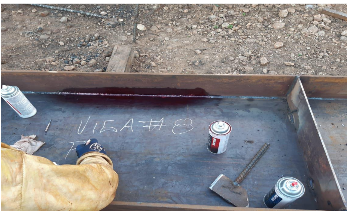
Ilustración 31 Prueba no Destructiva de Tinta para el Cordón de Soldadura (Limpiador)
