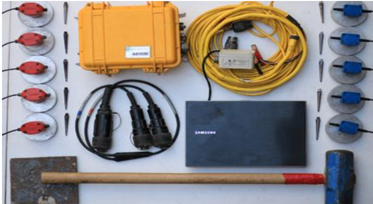
Figura 5. Sismógrafo GEODE de la empresa geometrics, geófonos rojos y azules, martillo de 14 libras, placa metálica, cable de conexión y computadora portatil.
