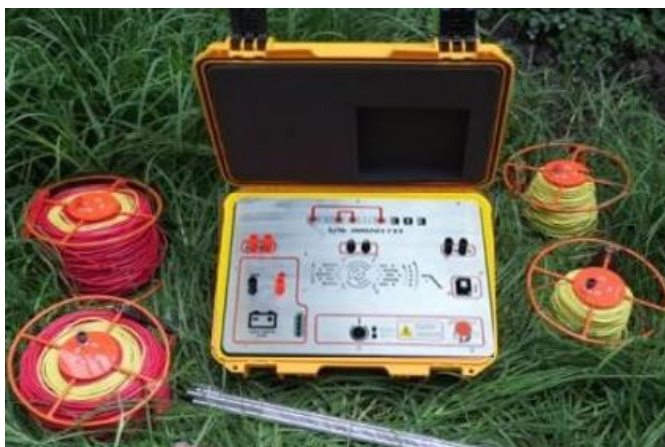
Figura 7. Equipo GeoAmp 303 SUBSUELO 3D.
