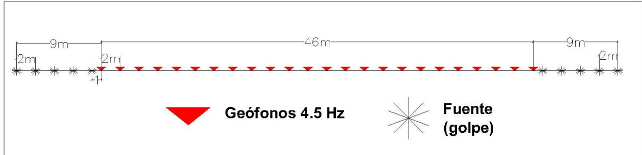
Figura 13: Distribución de MASW-1D. Fuente: Autor.
