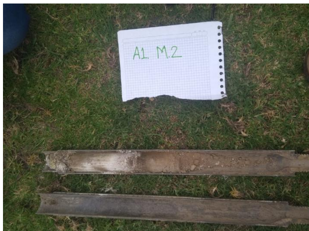
Figura 18: Caña partida ensayo SPT. Fuente: Foto in situ.
