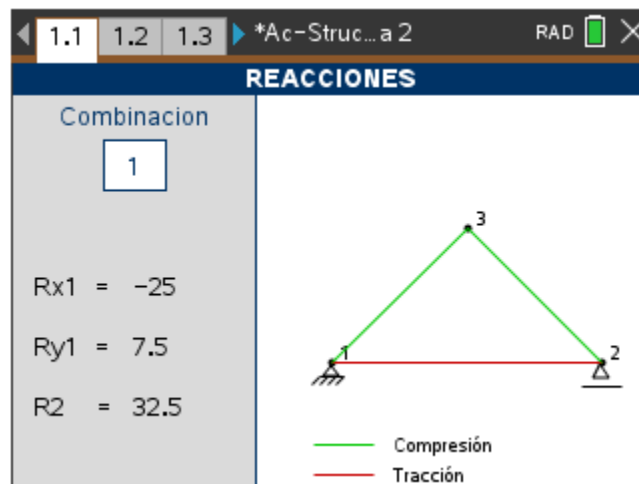
Figura 88: Ventana de reacciones de las armaduras isostáticas
