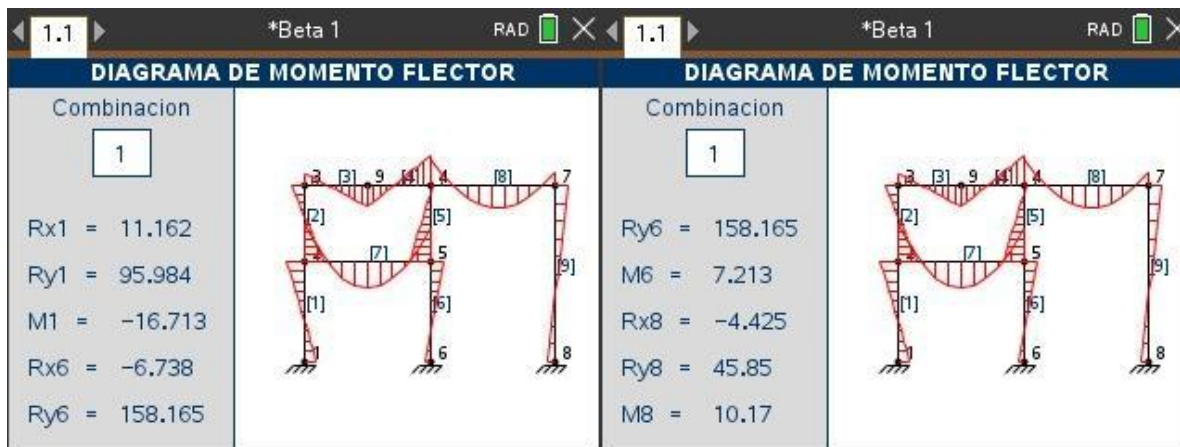
Figura 48: Reacciones problema 2 usando Ac-Struc
