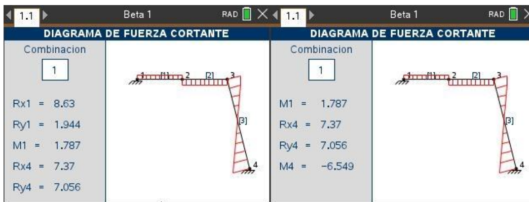
Figura 45: Reacciones problema 1 usando Ac-Struc
