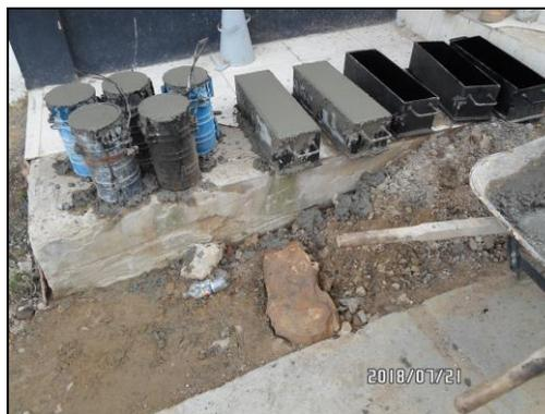
**Figura 38.** Muestreo para ensayos de resistencia de concreto.
