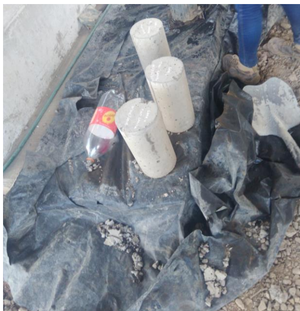
Ilustración 107 cilindros para prueba de resistencia concreto de cancha
