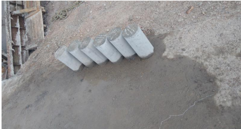
Ilustración 105 cilindros prueba de resistencia del concreto muro sur y viga inclinada
