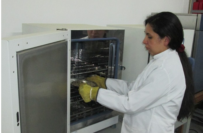
Figura 5. Ejecución ensayo de contenido de humedad.
