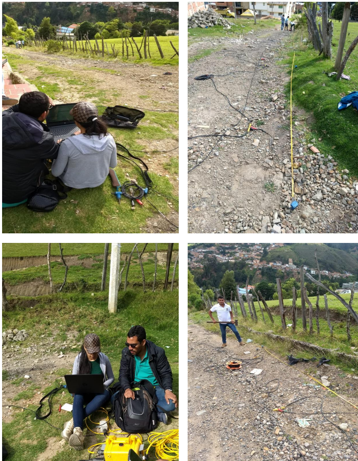
Figura 84. Ensayo de refracción sísmica
