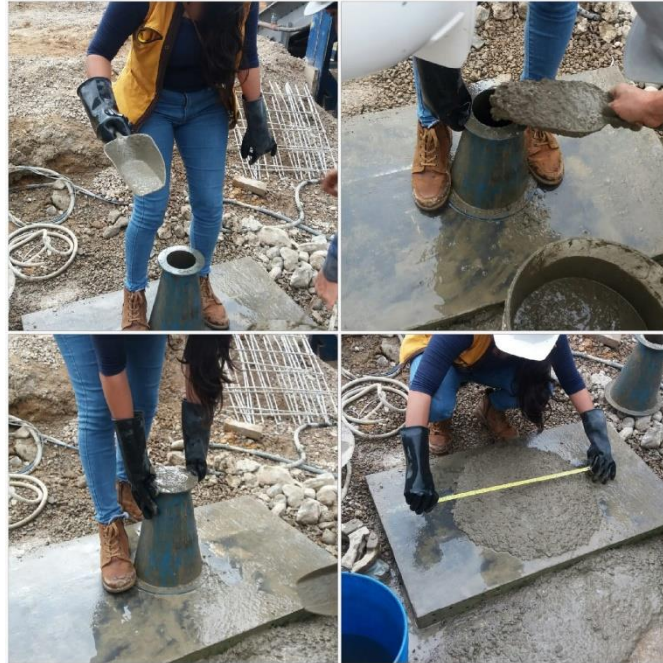
Ilustración 5. Toma de asentamiento.
