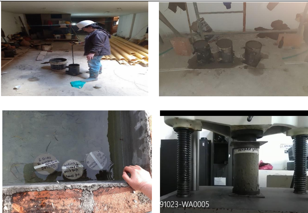
Ilustración 23. Ensayo de Resistencia al Concreto en vigas de Cimentación, Columnas y VGP
