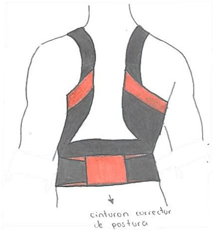
Ilustración 45 - Alternativa #5, corrector de postura para hombros, protector lumbar que en su interior tiene platinas y de ajuste velcro. Material textil elástico y polímeros.
