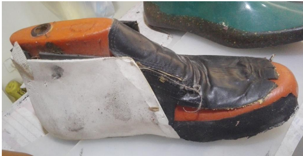
Fig.13 Configuración y adaptación de horma para pie con transformaciones
