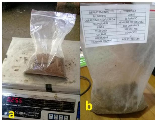
Figura 11. a) pesaje y b) etiquetado de las muestras para el envío a laboratorio. Fuente: El Autor.
