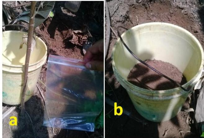
Figura 10. a) Bolsa plástica para la muestra final y b) balde que contiene todas las submuestras. Fuente: El Autor.
