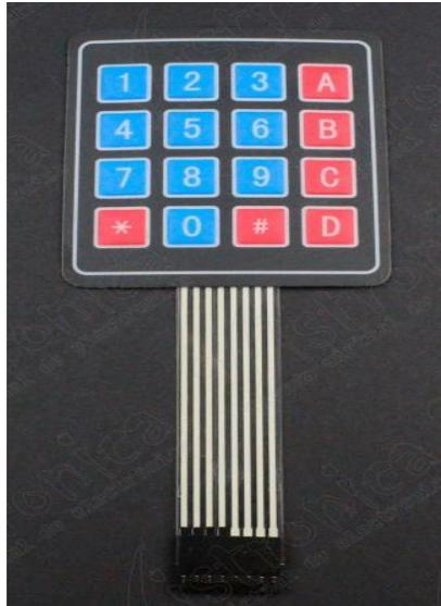
Figura 16. Teclado 4x4 Arduino.
