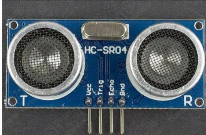
*Figura 4. Sensor ultrasonido HC-SR04.*
