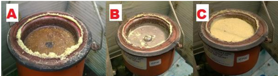
Figura 54: Comparación antes y después de la limpieza del vaporizador. A: Vaporizador sucio.
