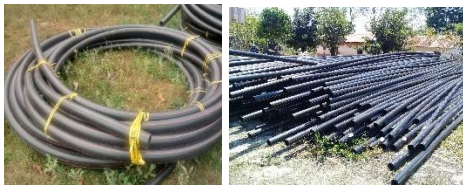
Ilustración 10. Tubería de 3" por 12 y 50 metros de longitud.
