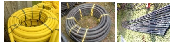
Ilustración 11. Tubería de 2" de 12 y 100 metros de longitud.
