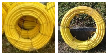
Ilustración 12. Tubería de 1", 3/4" y de 1/2" de 150 metros de longitud.
