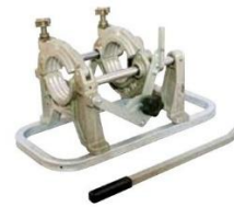
Ilustración 15. Equipo "carro" de termofusión.
