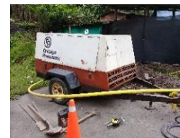
Ilustración 29. Compresor de aire para pruebas.
