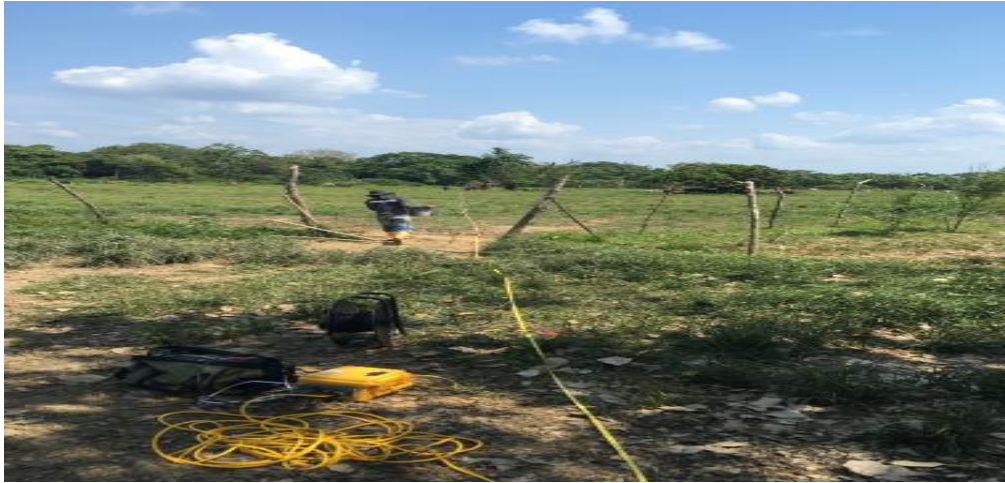
FIGURA 7, MONTAJE DE LA LINEA DE REFRACTION SISMICA EN EL MUNICIPIO DEL BAGRE
