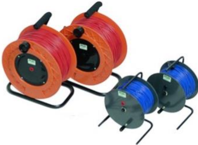
FIGURA 32, CARRETE CON LOS CABLES PARA TOMA DE DATOS SEVS
