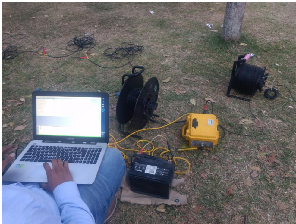
FIGURA 3, LINEA SISMICA MONTADA Y LISTA PARA LA TOMA DE DATOS
