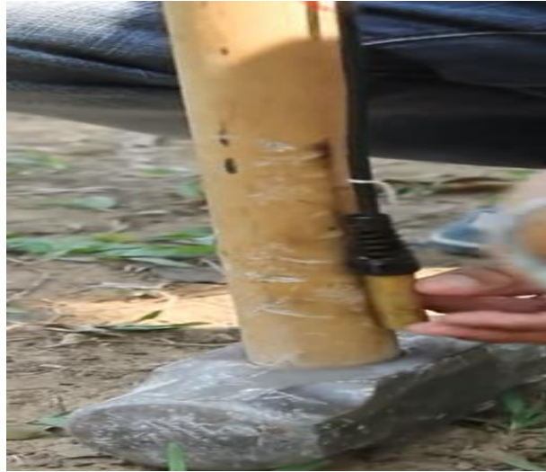
FIGURA 40, TIGGER CONECNTADO A LA CABEZA DE LA PORRA CON CINTA
