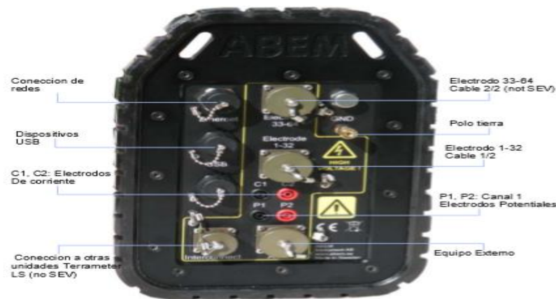
FIGURA 69, ENTRADA PARA CONEXIONES TERRAMETER LS
