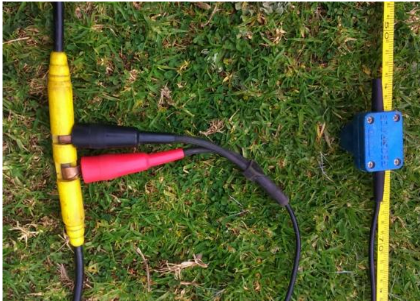
FIGURA 37, CONEXIÓN DEL GEÓFONO AL CABLE MULTICANAL
