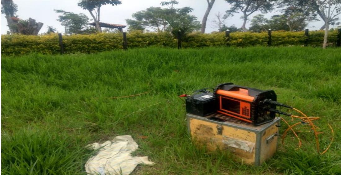
FIGURA 20, TOMA DE DATOS CON EL TERRAMETER LS EN LA MESA DE LOS SANTOS
