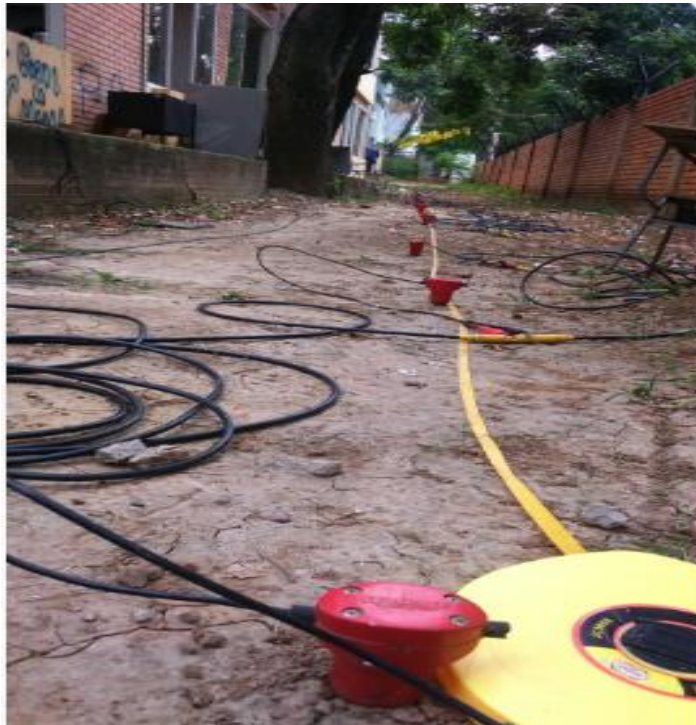
FIGURA 36, GEÓFONOS UBICADOS EN LÍNEA RECTA
