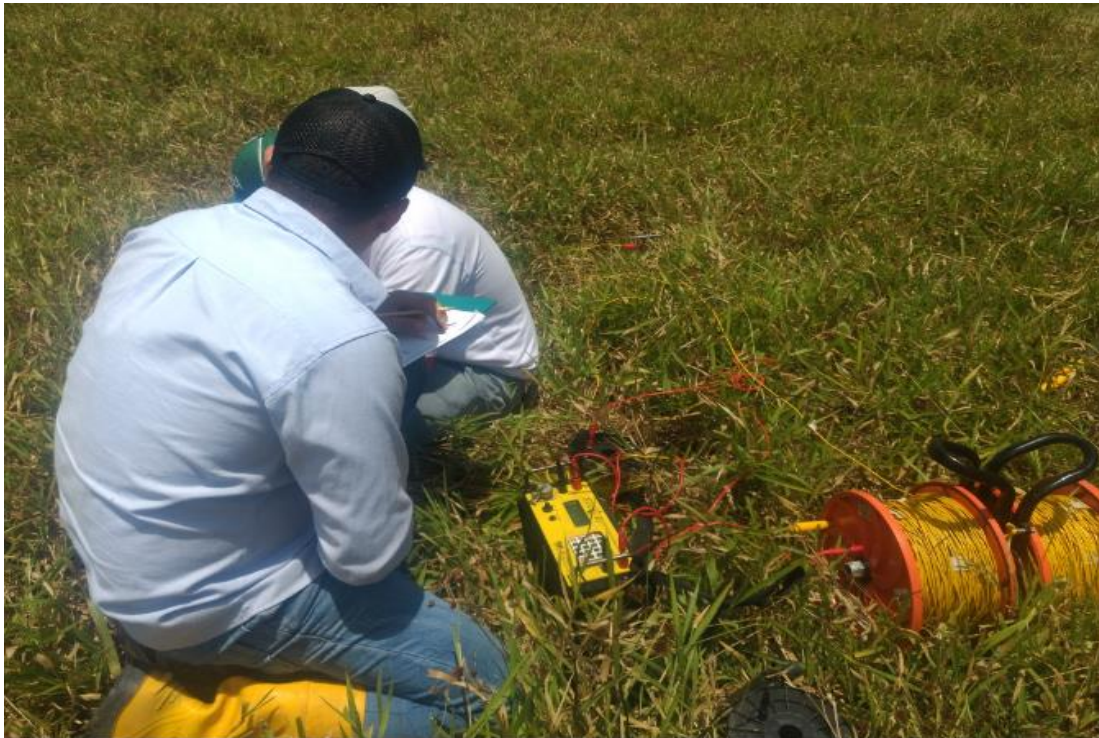
FIGURA 12, TOMA DE DATOS SEVS DISTANCIA AB/2 A 2 M
