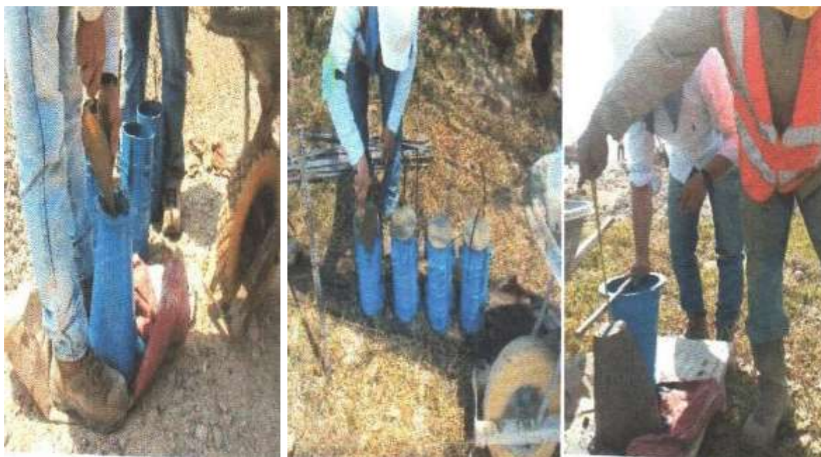
Figura 4. Registro fotográfico de algunos cilindros para las pruebas INVIAS E-410-13.
