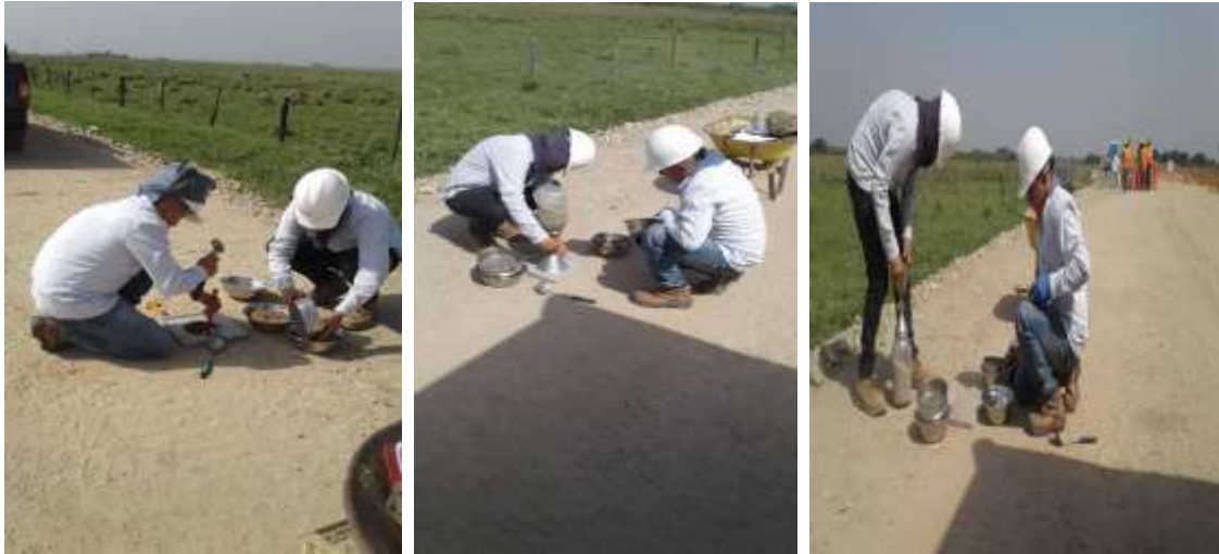
Figura 7. Registro fotográfico de las pruebas de densidad con el método del cono de densidad.
