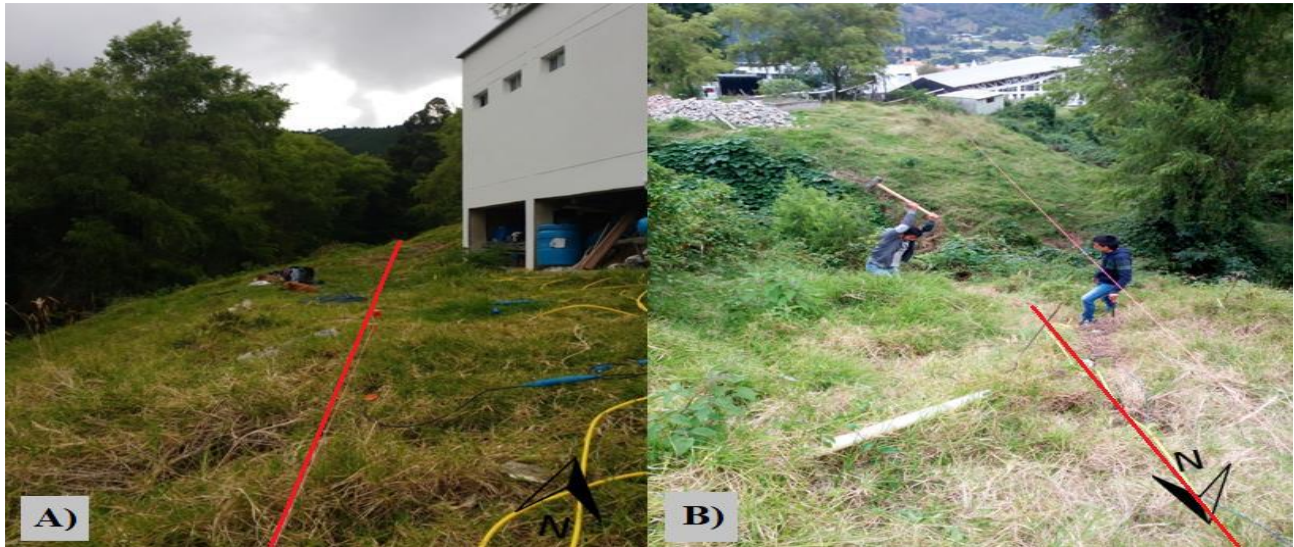
FIGURA 11: Adquisición de datos MASW. A) Tendido de adquisición de MASW. B) Disparos generados con maso de 16 lb. Fuente: Autor.
