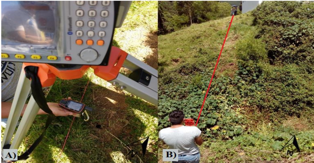
FIGURA 4: levantamiento topográfico. A) Georreferenciación de la Estación Total GEOMAX zoom 30 pro con el GPS MAP 64s Garmin. B) Levantamiento topográfico de la línea de estudio. Fuente: Autores
