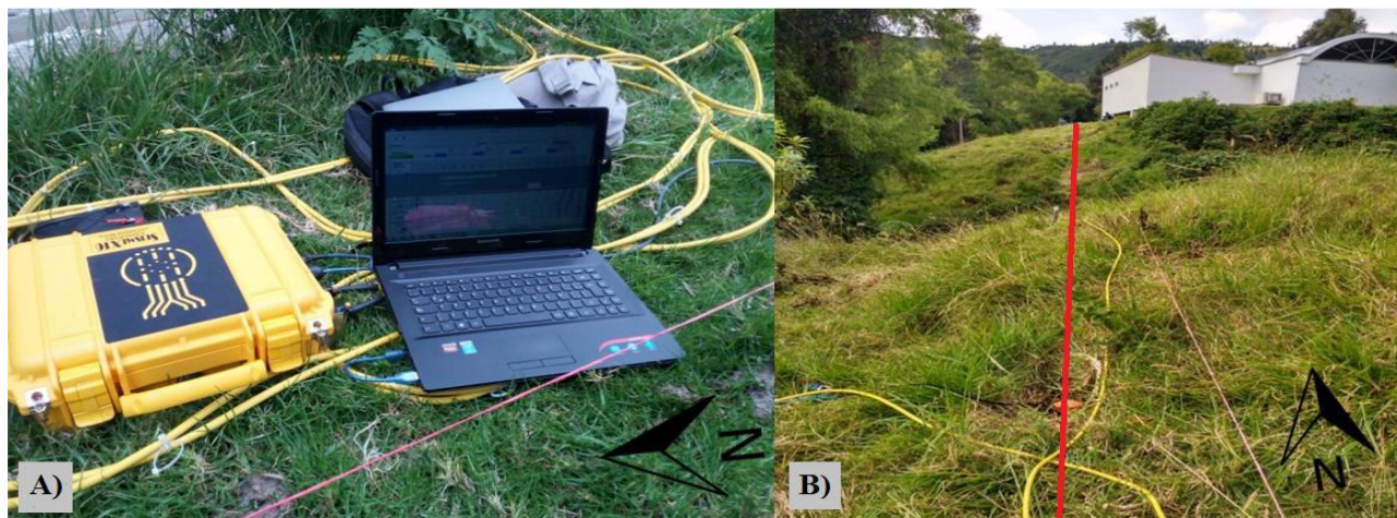
FIGURA 6: Adquisición de datos refracción sísmica. A) Sismógrafo conectado a un ordenador para la adquisición de los datos. B) Tendido de adquisición de Refracción sísmica. Fuente: Autor.
