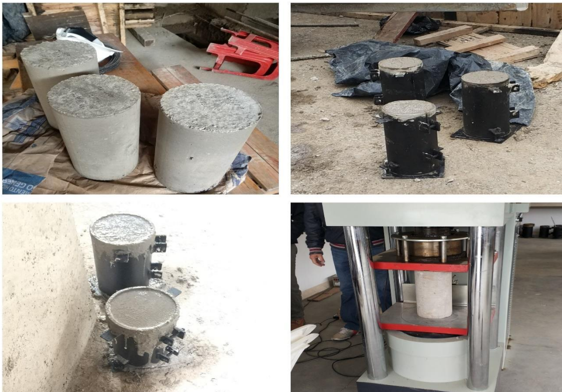
Ilustración 6 Toma de algunos cilindros de concreto para prueba de resistencia. Fuente Autor
