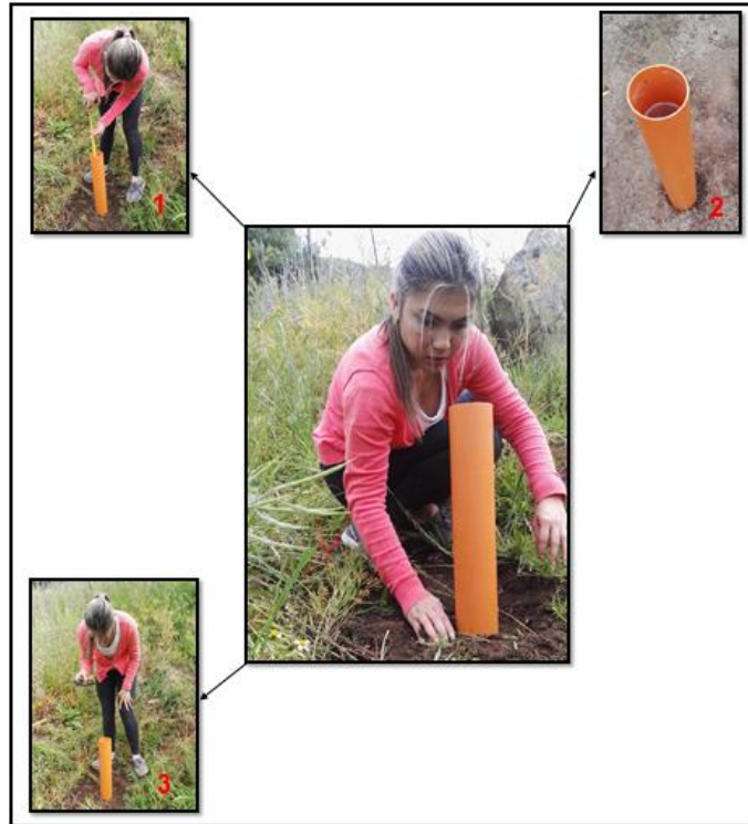
Figura 28. Permeabilidad del suelo.
