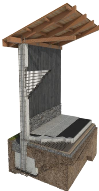
Figura 73 Detalle de zapata a cubierta.
