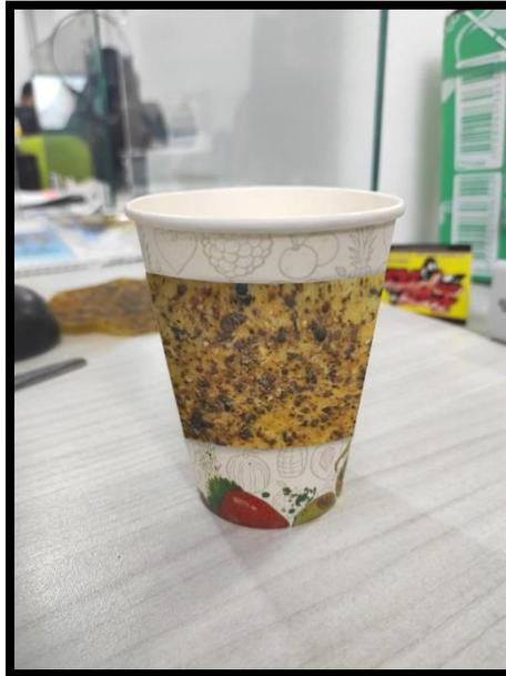
*Fig 25. Aislante térmico para bebidas calientes realizado con el prototipo F de bioplástico*
