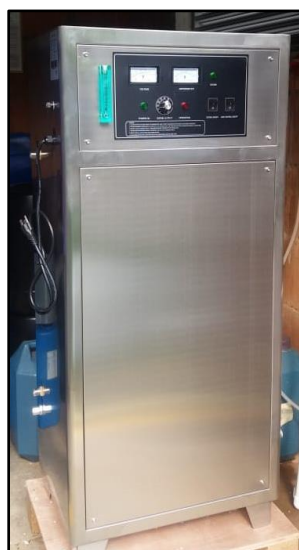
Figura 18. Fotografía del sistema de generación de ozono WTC S.A.S.
