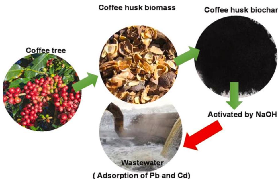
Figura 12. Proceso de obtención del adsorbente (Quyen et al., 2021).
