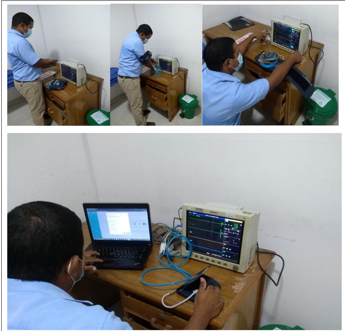
Figura 25. Mantenimiento preventivo de Monitor de Signos Vitales. [Autor]
