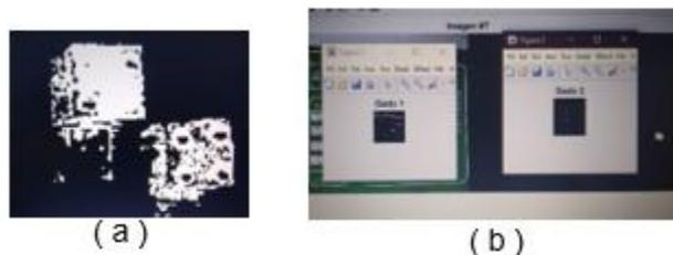
Figura 30. Problemas de segmentación del segundo entorno de trabajo a) deformación del objeto, b) baja definición en el recorte
