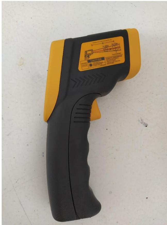
Figura 9. *Termómetro de rayo láser*
