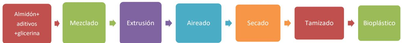
**Figura 11.** Esquema general del proceso para la obtención de bioplásticos a partir del almidón.
