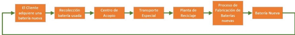
*Ilustración 3* – Proceso Logística Inversa Baterías Plomo Ácido usado actualmente
