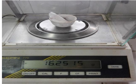
Fotografía 5. Capsula de Porcelana con filtro de fibra de vidrio.
