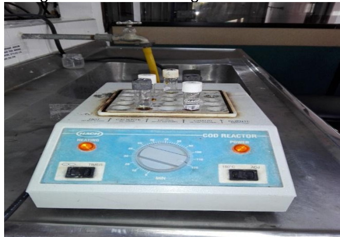
Fotografía 6. Tubos de digestión en el reactor.
