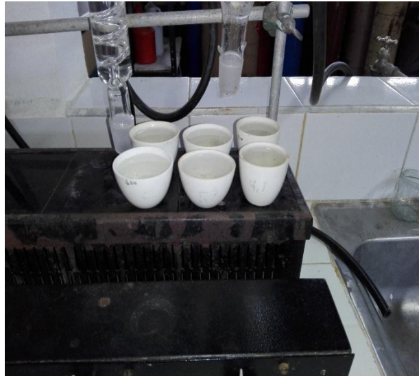
Fotografía 3. Capsulas de Porcelanas en la plancha.
