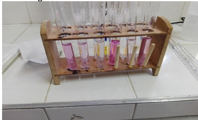
Fotografía 9. Determinación de Nitritos.
