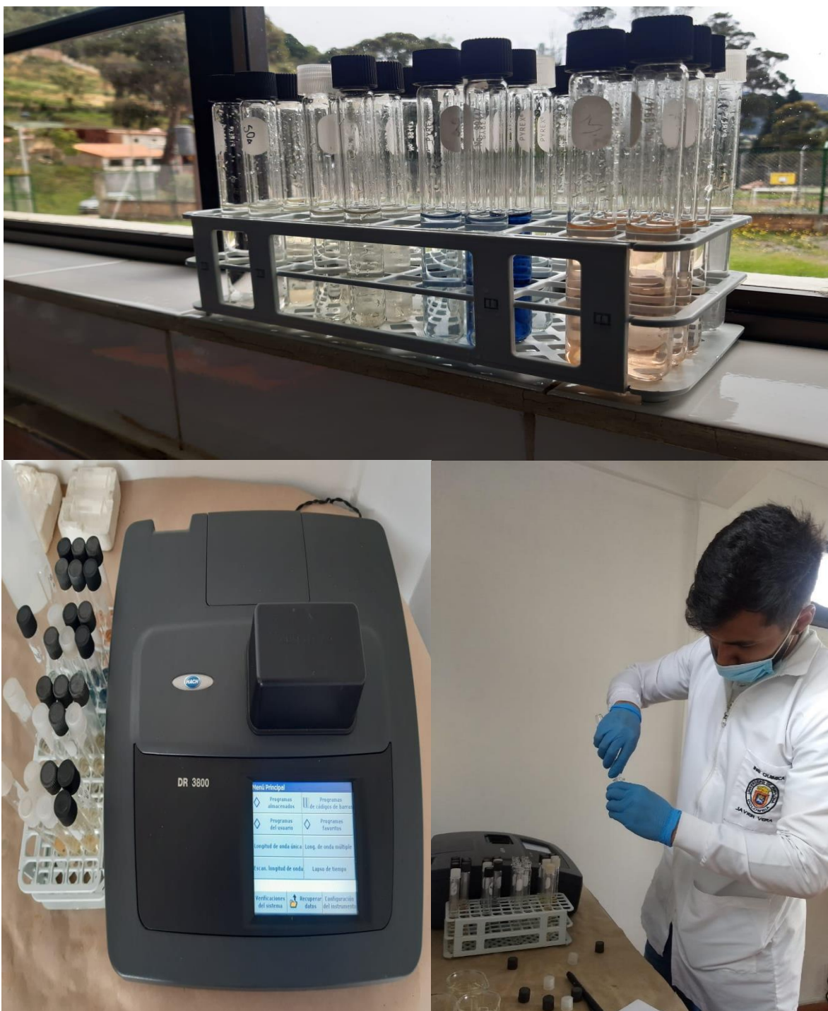
Figura 32. Procedimiento para el análisis de nitritos, nitratos, hierro total y fosfatos en el laboratorio de control de calidad de la universidad de Pamplona
