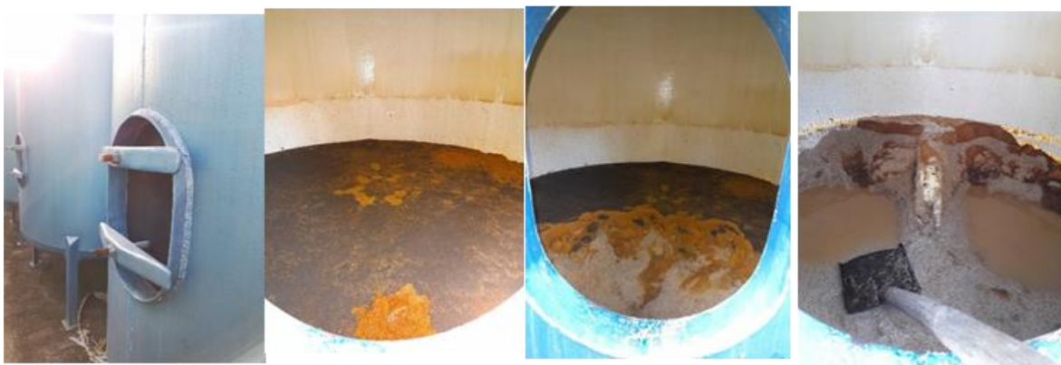
Figura 24 Metodología para desocupar las columnas de intercambio iónico
