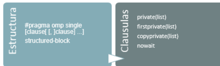
Figura 7. Estructura Y Clausulas Del Pragma Omp Single
