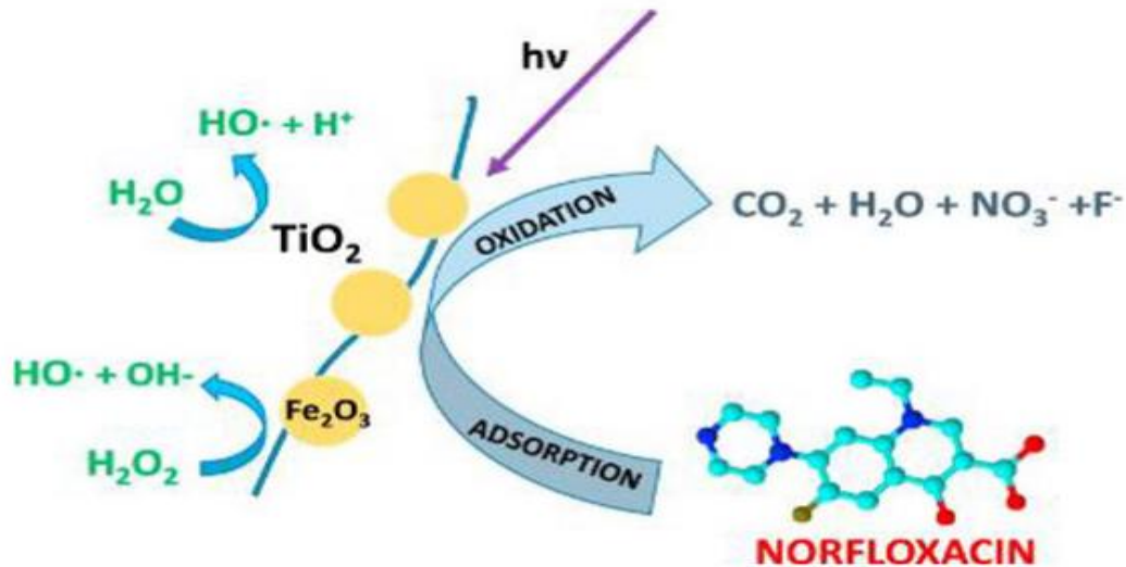
Figura 11. Los catalizadores desarrollados son capaces de convertir el antibiótico norfloxacino en sustancias minerales en presencia de luz y agua oxigenada
