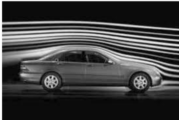
FIGURA 39. TÚNEL DE VIENTO VEHICULAR CON VISUALIZACIÓN DE FLUJO MEDIANTE HUMO.
