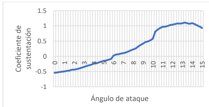
FIGURA 57. ÁNGULO DE ATAQUE VS SUSTENTACIÓN EN EL S835.
