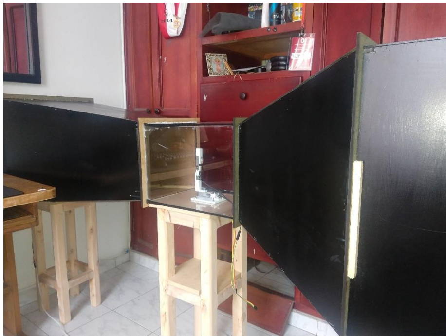
FIGURA 21. ENSAMBLAJE DE LA ESTRUCTURA DEL TÚNEL DE VIENTO.
