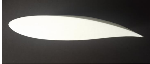
FIGURA 62. CONSTRUCCIÓN DEL MODELO AERODINÁMICO MEDIANTE GENERACIÓN ADITIVA.
