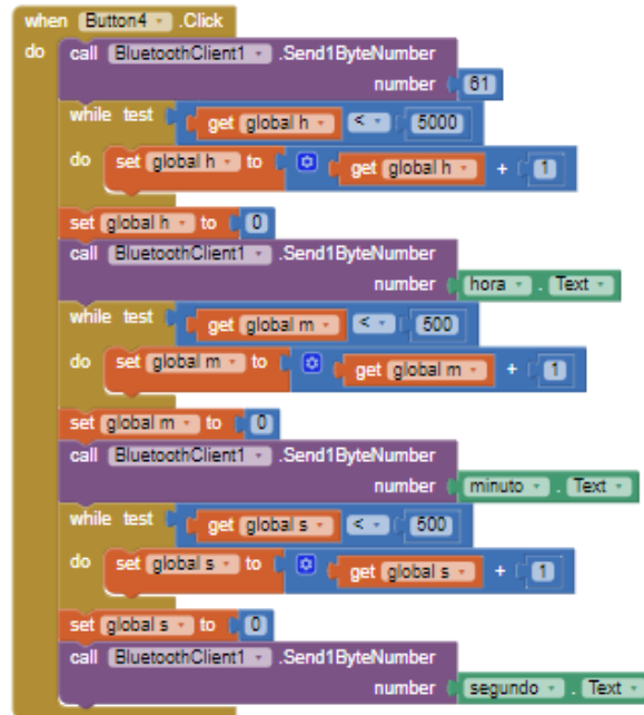
Ilustración 27. Envío de información desde la aplicación móvil al sistema embebido. Fuente: Autor.
