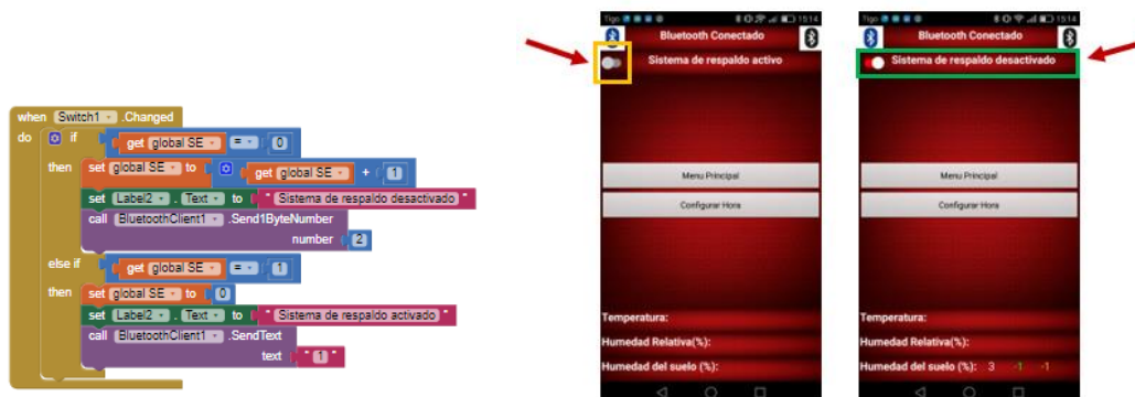
Ilustración 50. Bloqueo del sistema de respaldo. Fuente: Autor.
