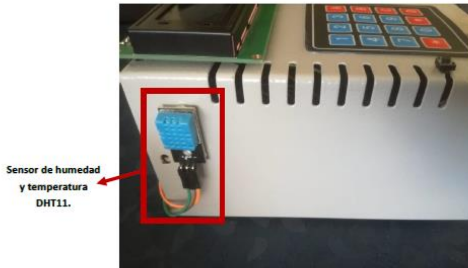
Fig. 4. Controlador de riego vista lateral.
