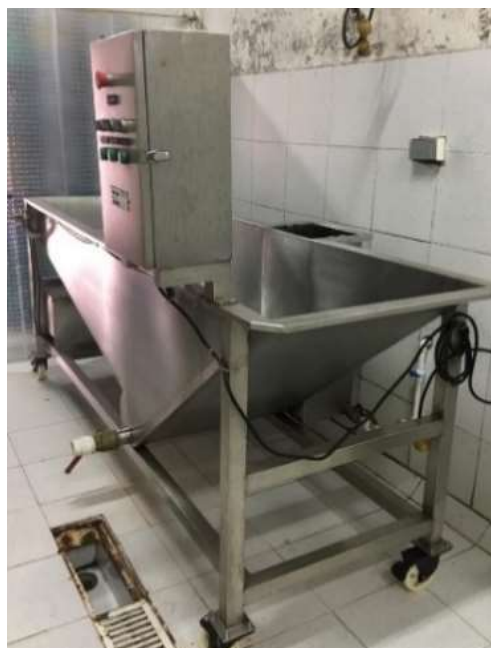
Figura 4. Tanque de lavado.
