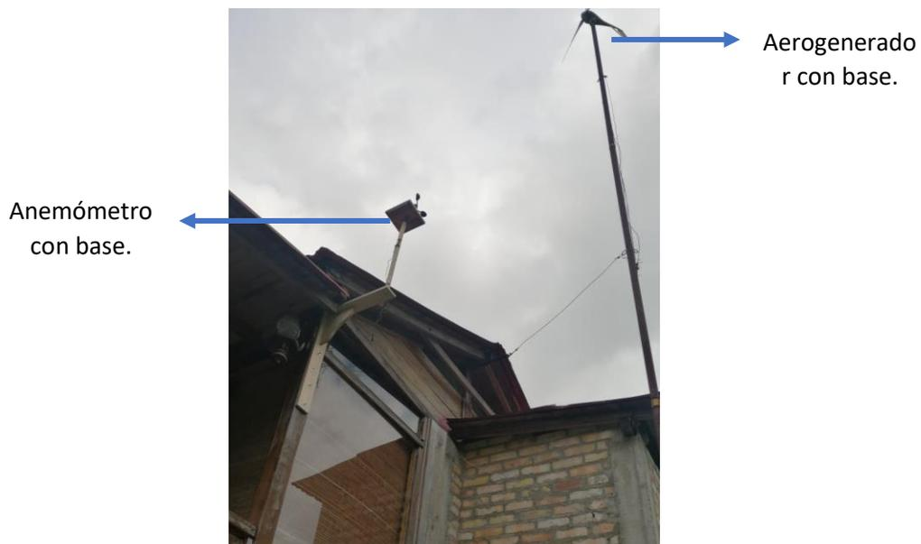
Figura 60. Anemómetro y sensor DHT11 instalados en una base de madera.
