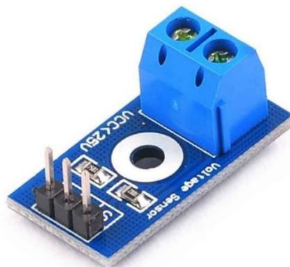
Figura 17. Sensor de voltaje FZ0430 con señal analógica de salida.
