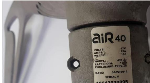
Figura 27 Características del aerogenerador AIR40.
