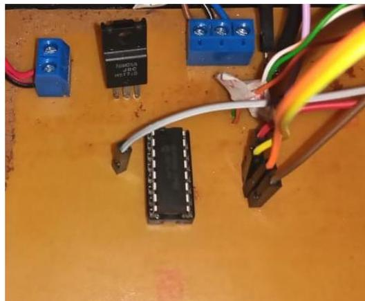
*Figura 23. PCB diseñada con componentes soldados.*
