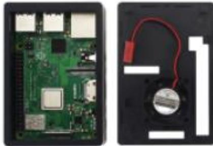
*Figura 9. Raspberry Pi 3B+, carcasa y ventilador.*
